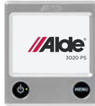
2. Järjestelmä käynnistetty, valodiodei palaa
